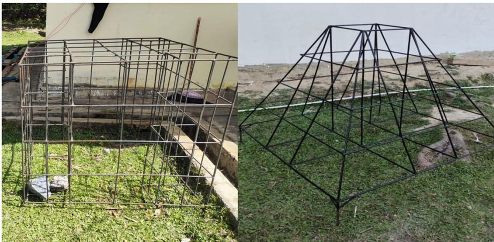
**Gambar 3.** Desain rangka fish shelter yang dibuat
