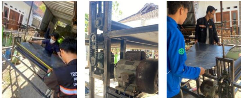
Gambar 5. Proses perakitan akhir Mesin Pelapis HPL
