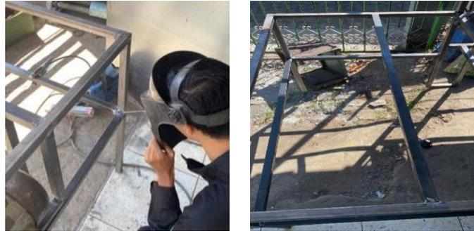
Gambar 4. Pembuatan Rangka mesin dan Rangka Penopang
