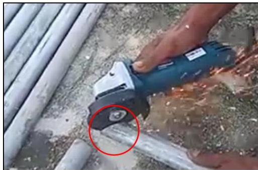
Gambar 4. Cara Pemotongan Besi Pipa (potongan miring)
